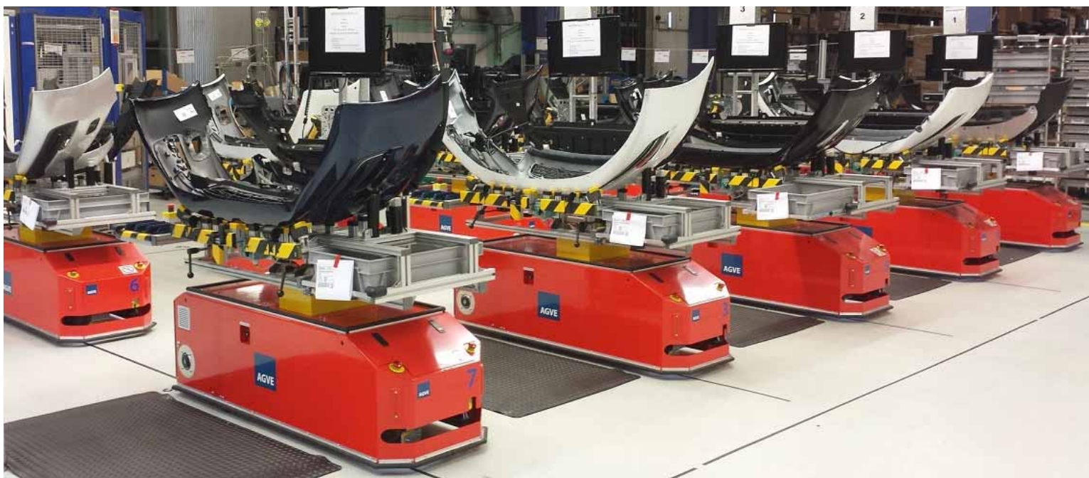
Sluiten de automatische lijnen niet op elkaar aan, dan kunnen AGV's worden gebruikt.
